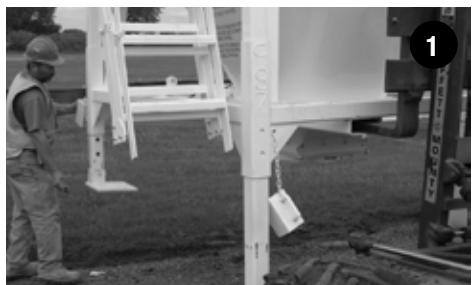
**Se prepara una cantidad doble de material en 5 minutos o menos sin sobrecargar al trabajador o poner en peligro la integridad de la mezcla. No se necesita electricidad ni agua a presión, solamente una mezcladora mecánica. El silo puede transportarse. A medida que avanza el trabajo, los trabajadores y la estación de mezclado con silo lo siguen.**
